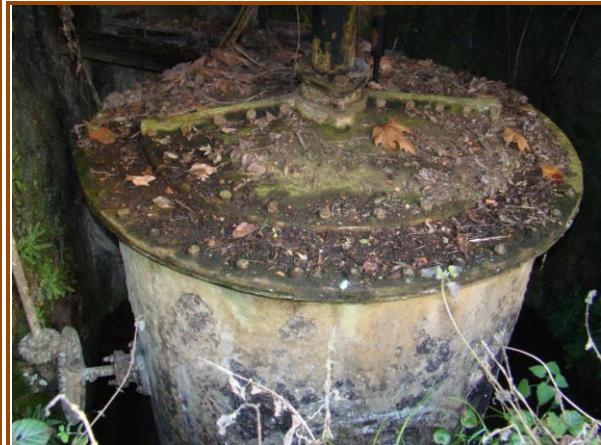
Turbine hydraulique à rotation horizontale
